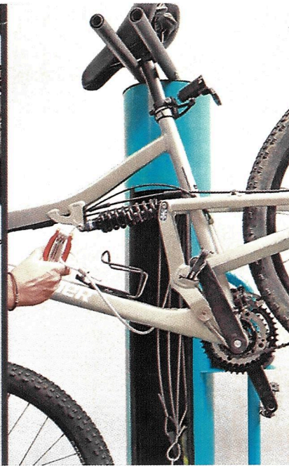
Sujeción superior de la estación Ajustes y auto reparado de la Bicicleta
